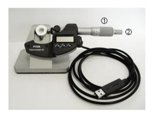
**9.** Datenübertragung auf den PC durch kurzes Drücken des Knopfes *DATA* an dem Mikrometer-Interface. Der gemessene Wert wird automatisch auf den PC übertragen und in dem geöffneten Programm angezeigt.
