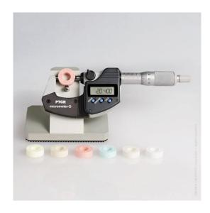
Zur genauen Bestimmung der Schwindung eines Prozess-Temperatur-Kontrollrings PTCR ist ein präziser und gleichbleibender Vermessungsprozess von entscheidender Bedeutung. Um dies zu gewährleisten, wurde eine spezielle digitale **Mikrometerschraube** mit passgenauer Aufnahme für die Ringe und USB-Schnittstelle zur Datenübertragung entwickelt. Durch die speziell entwickelte Halterung wird eine reproduzierbare Positionierung des PTCR im **Mikrometer** gewährleistet.
